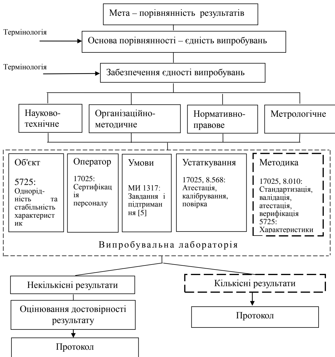
Рисунок 2 - Модель забезпечення єдності порівняльних випробувань
