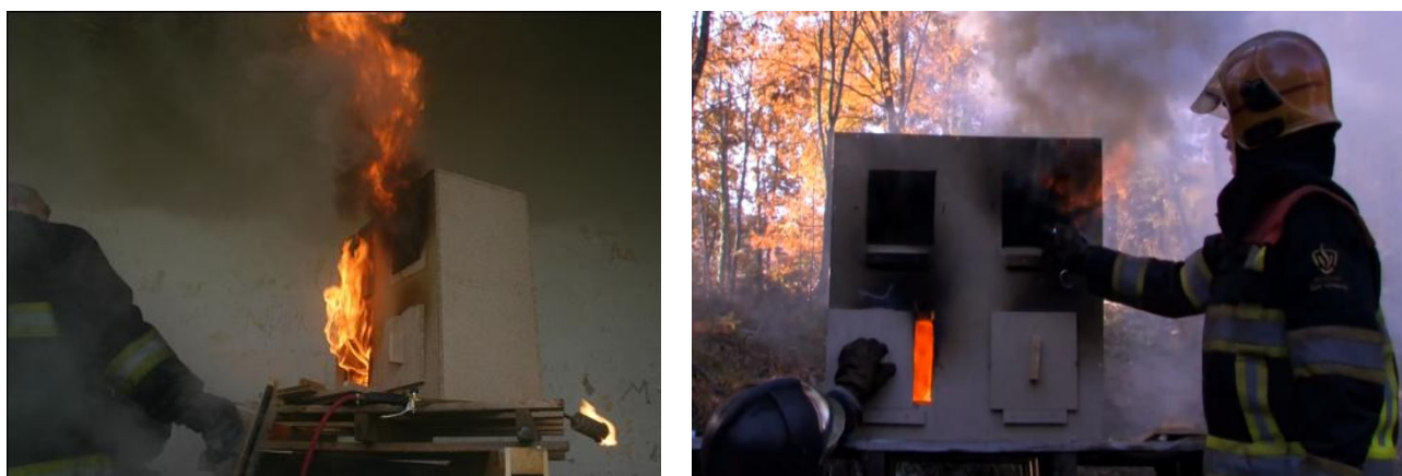
Рисунок 1 – Демонстрація розвитку пожежі в макетах житлових будинків
