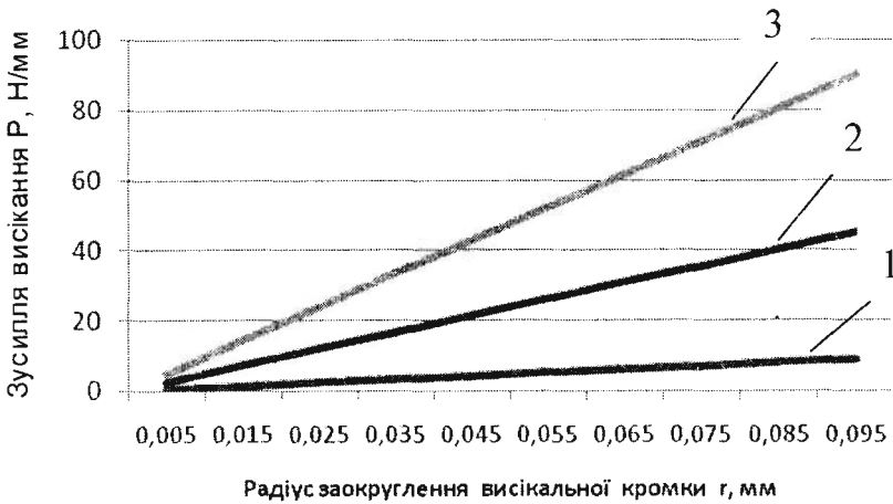
Рис. 2. Залежність зусилля висікання від радіуса заокруглення кромки при товщині картону: 1 — мінімальній (0,3 мм); 2 — середній (1,5 мм); 3 — максимальній (3,0 мм)
