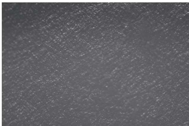
Рис. 2. Мікрофотографії поверхні хімічно осадженої міді з розчинів: а) гліцеринових; б) тартратних; в) трилонатних. Тривалість осадження — 5 хв.
