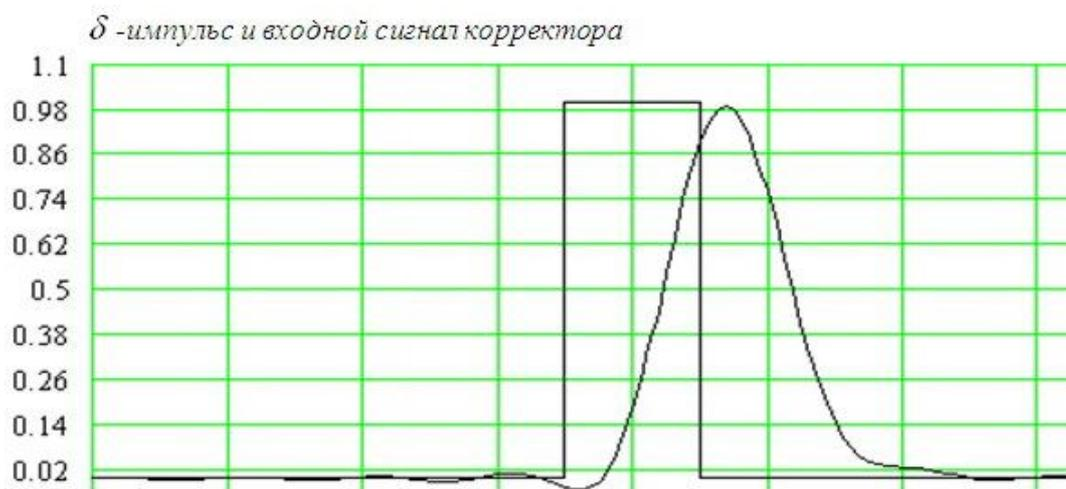
Рис. 6. Нахождение отсчётов импульсной характеристики
