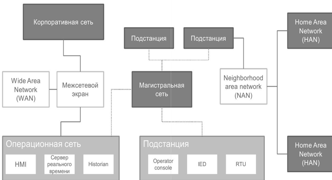
Рис. 1. Сетевая архитектура системы SMART GRID
