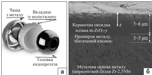
Рис. 3. Пара тертя ендопротеза Oxinium™ (а), SEM-зображення поперечного перерізу головки (б) [8]
