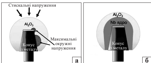
Рис. 4. Схематичне зображення ендопротеза головки стегнової кістки з кераміки Al 2 O 3 на металевій конусній шийці штучного суглоба: суцільна керамічна (а) та двошарова (Al 2 O 3 + Nb) головка (б)
