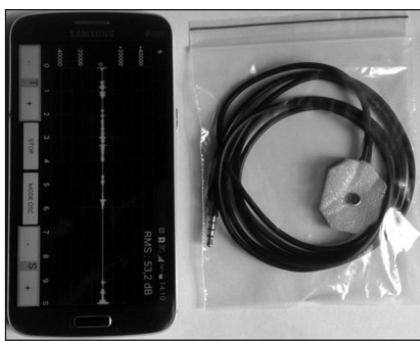
Рис. 2. Фото приладу для фіксації акустичних сигналів з колінного суглоба
