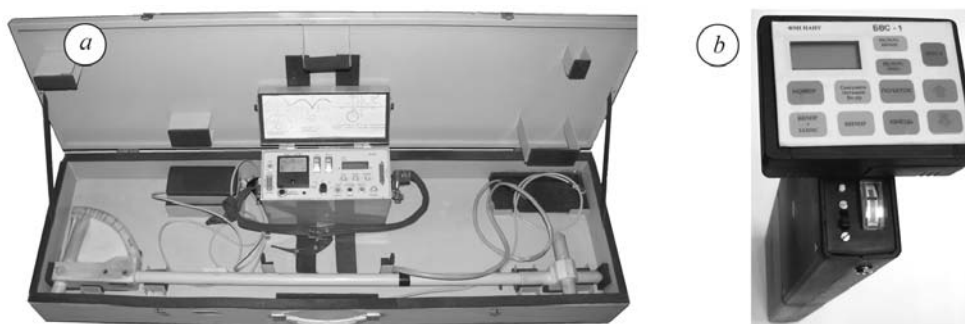
Рис. 6. Комплект апаратури БІТ-КВП для безконтактних вимірювань струму ПТ з корекцією відстані, з вольтметром і пам'яттю (а) та безконтактний вимірювач струмів і глибини залягання ПТ БВС-1 (b).
