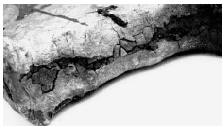
Рис. 4. Типові тріщини в нижній частині автентичних кутників з боку їх торців.
