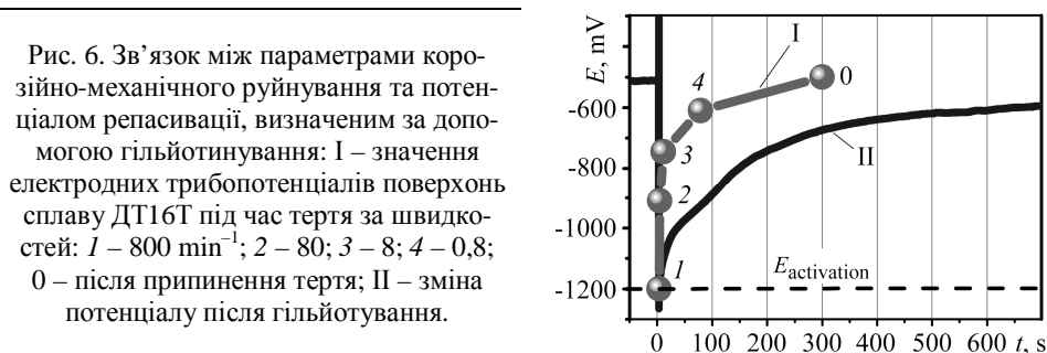
Рис. 6. Зв'язок між параметрами корозійно-механічного руйнування та потенціалом репасивації, визначеним за допомогою гільютинування: I – значення електродних трибопотенціалів поверхонь сплаву ДТ16Т під час тертя за швидкостей: 1 – 800 min -1 ; 2 – 80; 3 – 8; 4 – 0,8; 0 – після припинення тертя; II – зміна потенціалу після гільютування.
