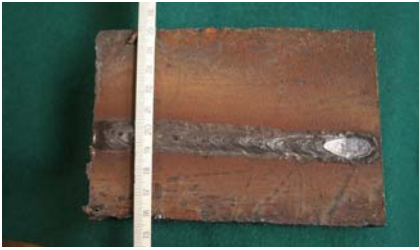
Рис. 6. Шов, наплавленный самозащитной проволокой ПП-АН7 диаметром 2,4 мм в режиме ИДСПЭ
