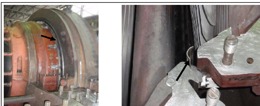
Рис. 11. Фотографии кольца, установленного на неподвижных частях ступени ЦНД турбины мощностью 225 МВт
