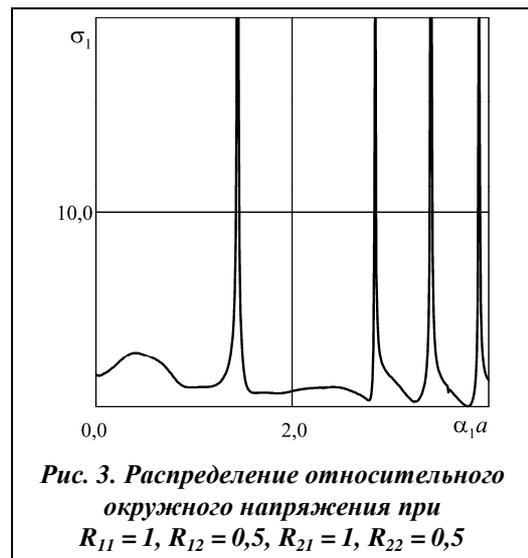
Кривые 1, 2 (рис. 2) построены при  $d = 2$ ,  $R_{11} = R_{12} = R_{21} = R_{22} = 1$  и значениях коэффициента Пуассона  $\nu = 0,15$  и  $\nu = 0,35$  соответственно. Кривая (рис. 3) построена при  $d = 2$ ,  $R_{11} = 1, R_{12} = 0,5, R_{21} = 1, R_{22} = 0,5$  и значениях коэффициента Пуассона  $\nu = 0,35$ . Кривая (рис. 4) построена при  $d = 2$ ,  $R_{11} = 1, R_{12} = 0,4, R_{21} = 1, R_{22} = 0,4$  и значениях коэффициента Пуассона  $\nu = 0,35$ .
