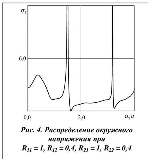
Рис. 4. Распределение окружного напряжения при  $R_{11} = 1, R_{12} = 0,4, R_{21} = 1, R_{22} = 0,4$
