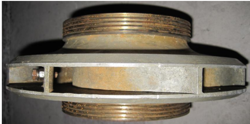
Рисунок 1 – Фото встановлення до робочого колеса насоса додаткової маси, що імітує потрапляння стороннього тіла та викликає додатковий дисбаланс
