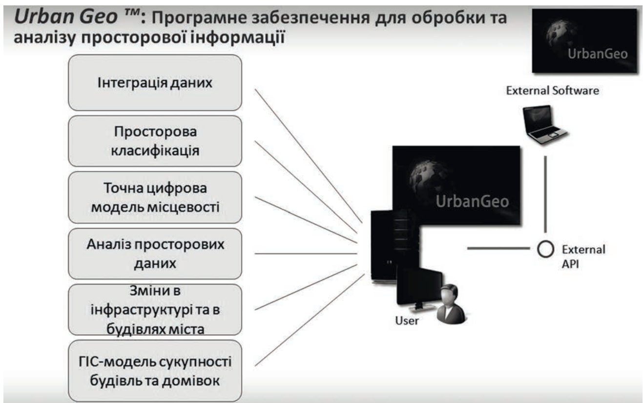
Рис. 2. Особливості архітектури та функціональності програмно-апаратного комплексу UrbanGeo™
