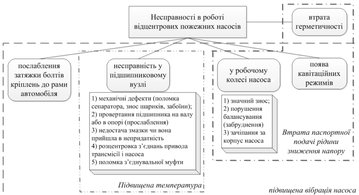
Рисунок 2 – Характерні несправності елементів пожежного насоса.
