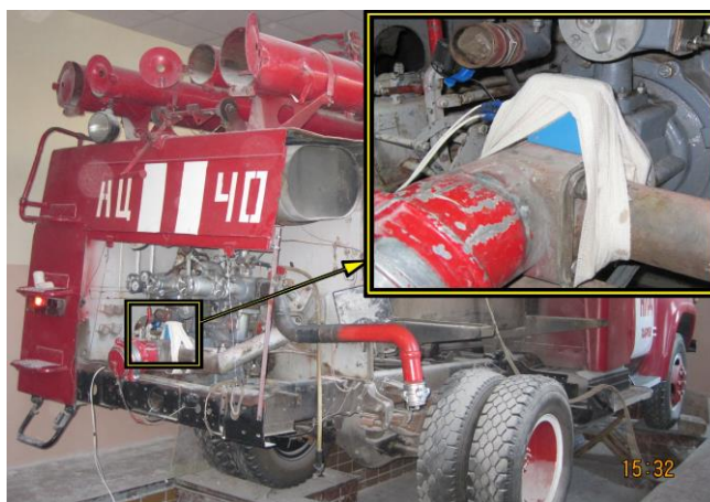
Рисунок 3 – Розміщення датчика вібрацій на корпусі насоса.
