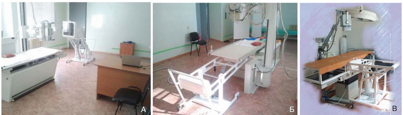
Рис. 3. Приклади доукомплектування працюючого рентгенівського обладнання цифровим приймачем: а, б – рентгенодіагностичного комплексу на 2 робочих місця; в – палатного рентгенапарата, що використовується в операційній травматологічного відділення
