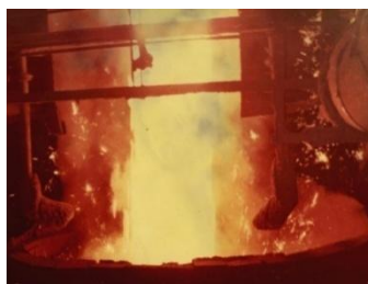
Рисунок 1 – Перелив чугуна из миксера в ковш
