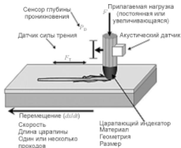
Рис. 6. Схема метода склерометрии.
