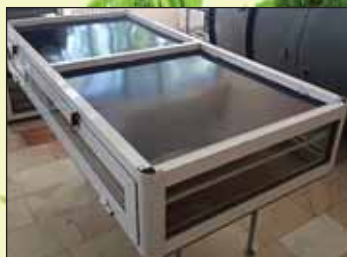
Рис.1. Гелио сушильная установка с аккумуляцией солнечной энергии
