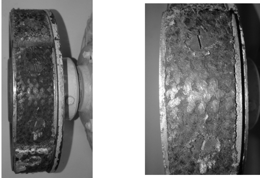
Рис. 3 – Стан фрикційної накладки колодки
