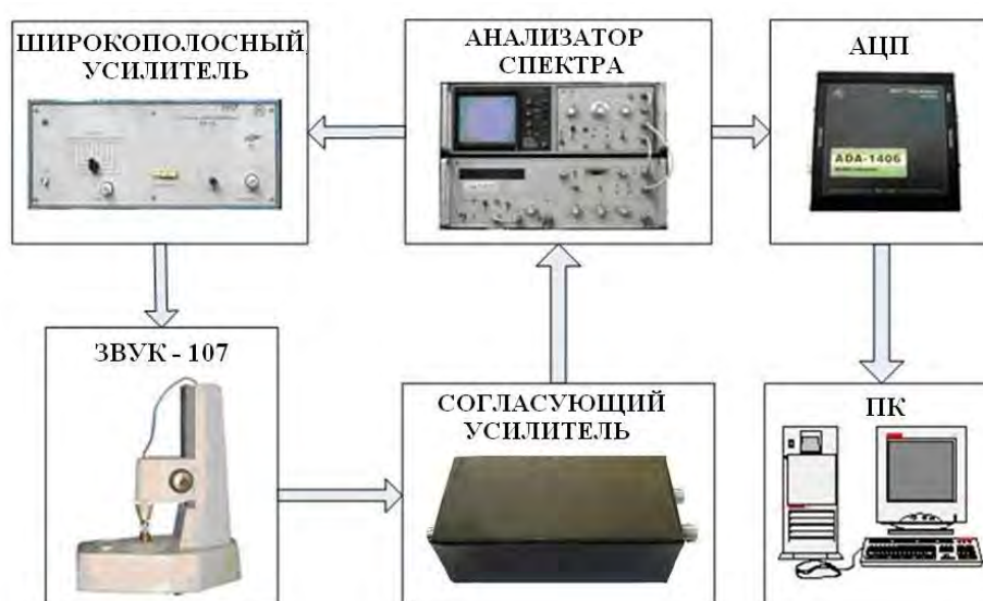
Рис. 1. Схема системы контроля демпфирующих свойств
