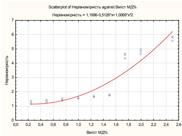
Рис. 4. Вплив відсоткового вмісту магнітних домішок на нерівномірність лінії штрихових кодів
