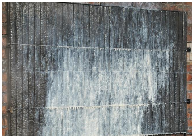
Рис. 3 Адгезія шару гелю на поверхні модельного вогнища з деревини
