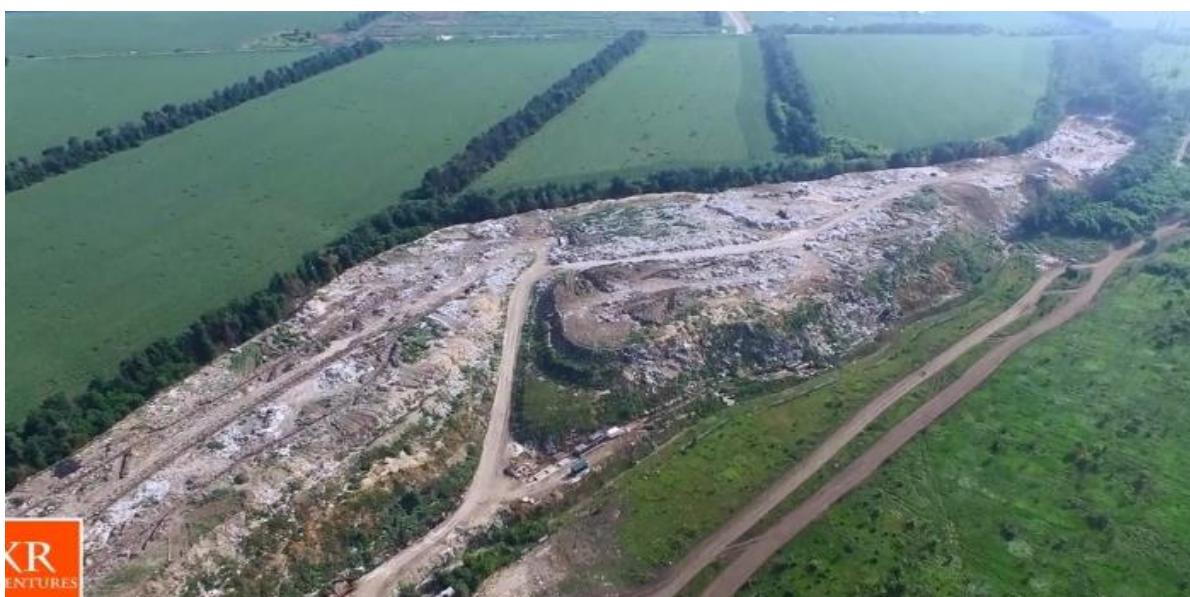
Рисунок 3 – Вигляд на робочі карти полігона з під'їзною дорогою та польовою дорогою для ґрунтовозів (фото з квадрокоптера)
