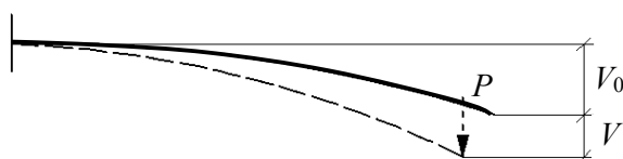
Рис. 4. Предварительно изогнутая консольная балка
