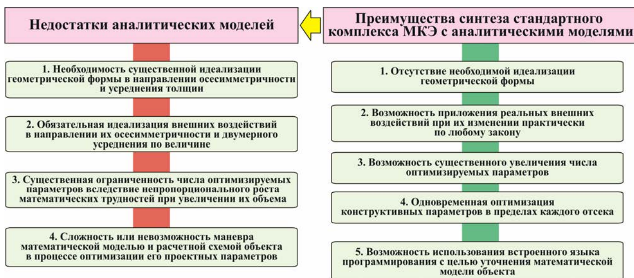
Рисунок 3 – Недостатки аналитических моделей и преимущества синтеза стандартного комплекса МКЭ с аналитическими моделями для оптимизации многоотсековых трехслойных оболочек из ПКМ с СЗ
