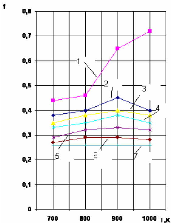
Рисунок 8 – Влияние температуры на коэффициент трения покоя для сплавов 1.ВТ14 BK6: покрытия: 2. \text{Mo}_2\text{N} , 3. \text{ZrN} , 4. 0,2\text{HfN} + 0,8\text{ZrN} , 5. 0,5 \text{ AlN} + 0,5 \text{ TiN} , 6. \text{Cr}_3\text{N}_2 , 7. \text{TaN}
