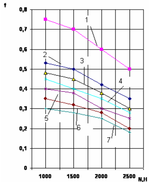
Рисунок 13 – Влияние нормальной нагрузки на коэффициент трения покоя - 1.ВТ14 BK6: покрытия: 2. Mo 2 N, 3. ZrN, 4. 0,2HfN + 0,8ZrN, 5. 0,5 AlN + 0,5 TiN, 6. Cr 3 N 2 , 7. TaN
