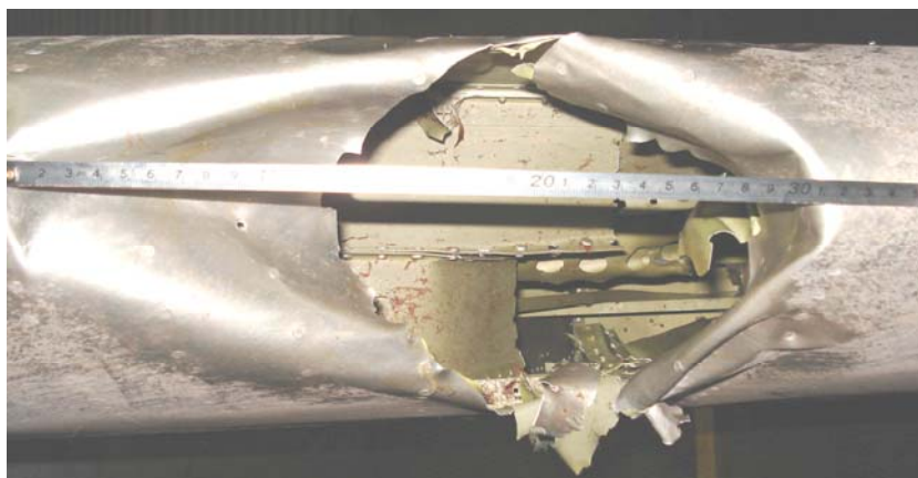
Рисунок 10 – Разрушения киля в эксперименте № 3
