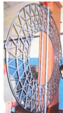
Рисунок 4 – Рама детектора переходного излучения (проект ATLAS)
