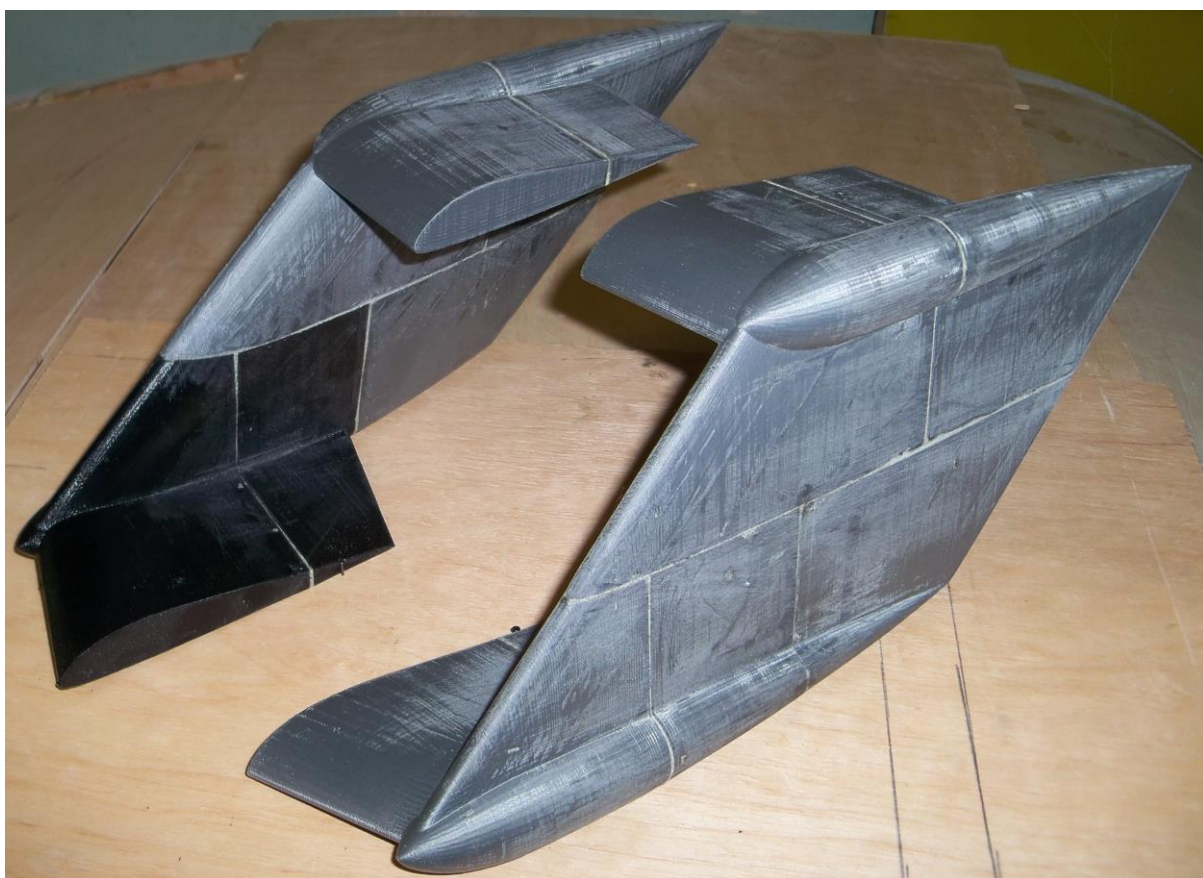
Рисунок 6 – Модели КАП № 1 (а) и КАП № 2 (б), реализованные с помощью технологии FDM
