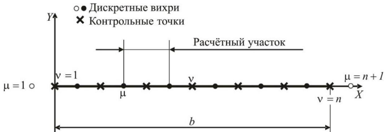
Рисунок 3 – К вихревой схеме нестационарной отрывной задачи
