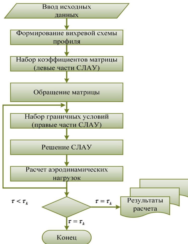
Рисунок 2 – К алгоритму расчета нелинейной задачи об отрывном обтекании бесконечно тонкого профиля
