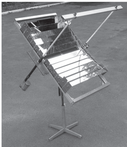
Рис. 1. Конструкція (а) та фото (б) Установки. 1 — концентратор, 2 — плоскі дзеркала, 3 — шарнір з двома незалежними осями, 4 — монтажна площадка для ФП та СМ, 5 — противаги, 6 — опорно-поворотна система
