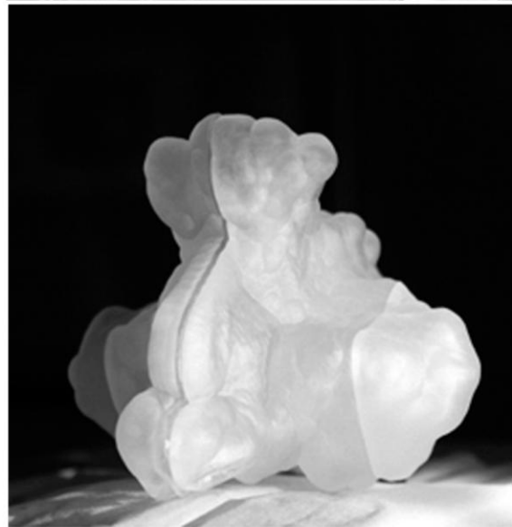
Рис. 2. Модель носовой полости и околоносовых пазух, полученная методом стереолитографии
