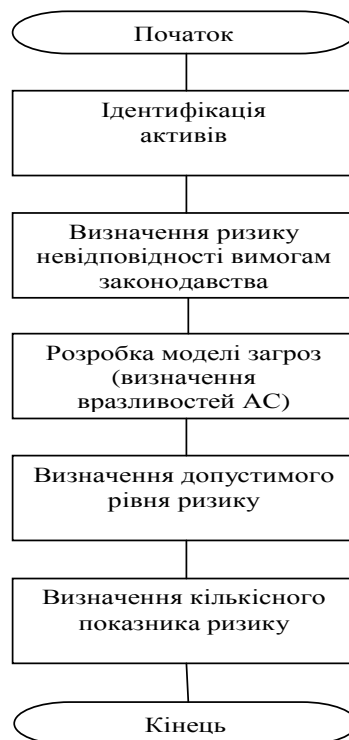
Рис. 1. Схема алгоритму оцінювання ризику ІБ
