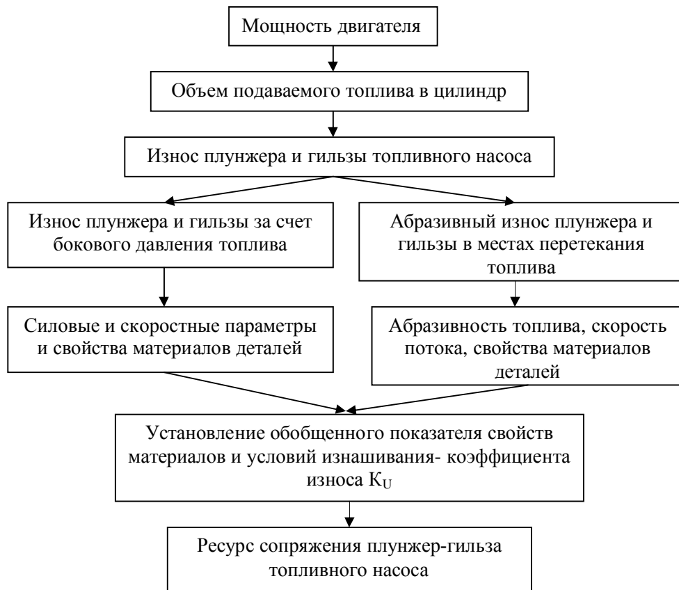
Рис. 1. Схема определения ресурса плунжерных пар топливного насоса.
