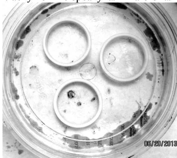
Рис. 5 . Кільця з фторопласту в середовищі біопалива.
