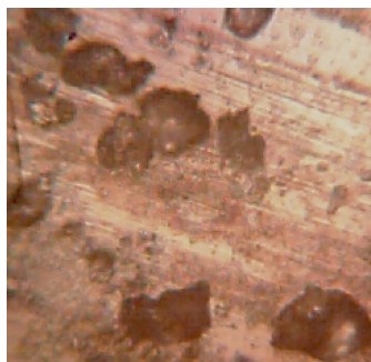
Рис. 2. Конгломераты продуктов износа, попавшие в зону трения. Процесс трения стали 45 по стеклу при P=1 МПа, V=0,1 м/с в динамике ( \times 125 )
