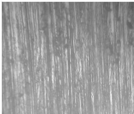
Рис. 5. Поверхня тертя контртіла після випробування неазотованого титанового сплаву BT9 при V = 2 м/с \times 100
