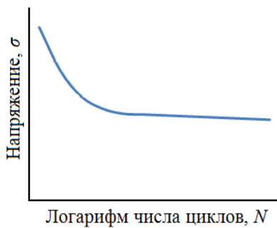
Рис. 2. Типичная \sigma - N – кривая для стали 35ХНЛ
