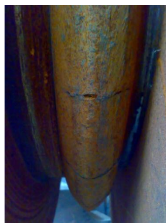
Рисунок 2 – Поверхность валка рельсобалочного стана 800 ПАО «ЕВРАЗ-ДМЗ им. Петровского», подвергшаяся адгезии с последующим глубинным вырыванием
