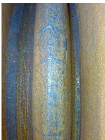
Рисунок 1 – Сетка разгара на поверхности валка рельсобалочного стана 800 ПАО «ЕВРАЗ-ДМЗ им. Петровского»
