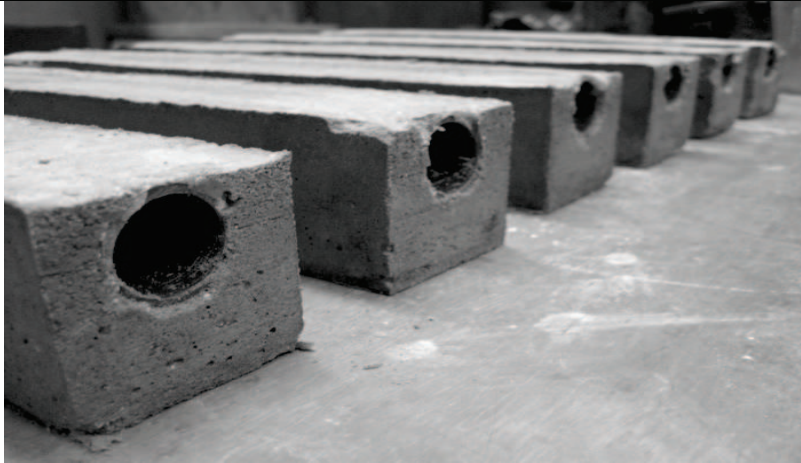
Рисунок 2 – Расположение в бетонном образце полимерной трубки
