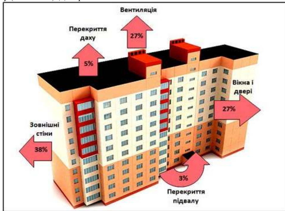
Рис. 3. Структура втрат теплової енергії будинком
