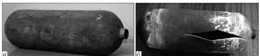
Рис. 4. Общий вид баллона: а — до испытания; б — после испытания
