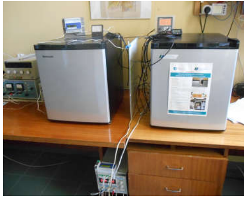
Рис. 4. Порівнювані об'єкти під час паралельних випробувань: ліворуч – холодильник Ravanson LK-48, праворуч – холодильник ХТТ-48-1
