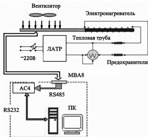
Рис. 3. Схема экспериментальной установки
