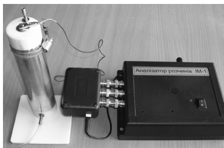
Рис. 1. Портативный импедансный измеритель со специальной электролитической ячейкой, разработанной для исследования жидких растворов с малым значением диэлектрической проницаемости и большим удельным сопротивлением
