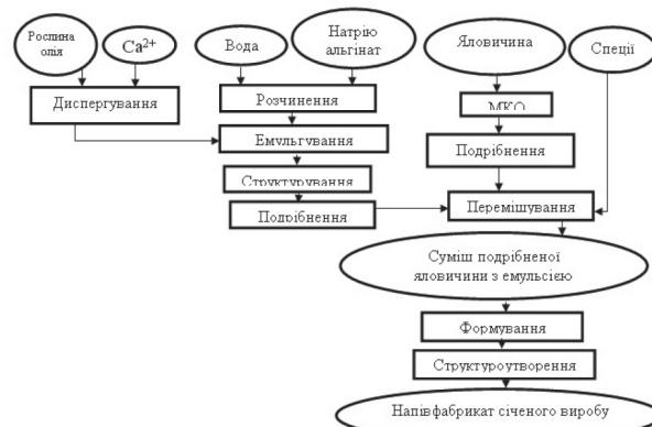
Рис. 4. Модель технологічної схеми виробництва м'ясних січених виробів з використанням попередньо структурованої емульсії
