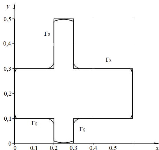
Рис. 1. Граница  $\Gamma_S$  области  $\Omega_S$ , построенная с помощью  $S$ -функций
